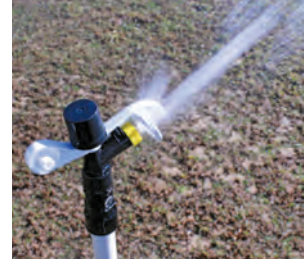
يوزع الرذاذ بعض من التيار المتدفق بالقرب من الرشاش؛ لتعزيز اتساق التوزيع.
