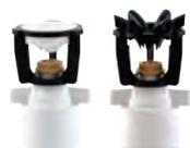
Ambos os modelos verticais do mini-Wobbler estão disponíveis com uma conexão deslizante antifurto. Basta colar um tubo de subida de PVC de 1/2" na parte interna da base deslizante ou de 3/4" na parte externa da base. Não são necessárias conexões de PVC na instalação.
