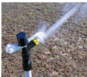
Диффузор распределяет часть водного потока вблизи дождевателя, обеспечивая более равномерную подачу.
