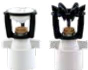
Ambos modelos verticales del mini-Wobbler están disponibles con una conexión deslizante antirrobo. Simplemente pegue un elevador de PVC de 1/2" al interior de la base deslizante o pegue un elevador de PVC de 3/4" al exterior de la base deslizante. No es necesario ningún accesorio de PVC para la instalación.
