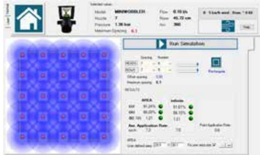
Basado en los parámetros del sistema, el mini-Wobbler puede alcanzar altos porcentajes de CU (Coeficiente de Uniformidad) y UD (Uniformidad de Distribución). El CP (Coeficiente de Programación) está cerca de 1, lo que significa que el sistema puede funcionar durante un período de tiempo más corto y aún así garantizar una cobertura adecuada en las áreas más secas.
