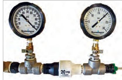
Se o seu fornecedor de produtos de irrigação tiver um dispositivo de testes de regulagem, você poderá também verificar as leituras em outro regulador de pressão que corresponda ao modelo que você estiver testando.
