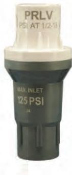
A válvula limitadora reguladora de pressão PRLV (Pressure Regulating Limit Valve) da Senninger foi projetada para ser usada no lugar do regulador de pressão de água padrão para limitar a pressão estática (sem fluxo) da água quando a válvula de fechamento é usada a jusante do ponto de regulação.
