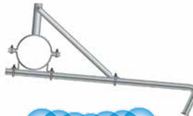
Adaptadores de tirantes SEM Barras Sling Finger na torre
