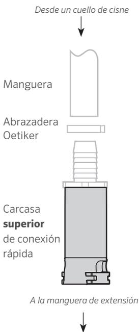
**CONEXIÓN DEL TRAMO DE MANGUERA DE EXTENSIÓN A UNA MANGUERA DE DESCENSO:**
