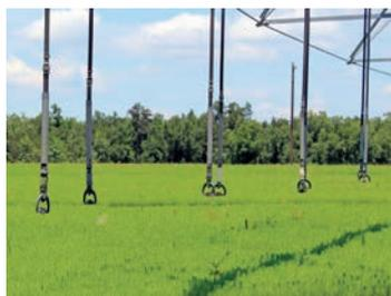
Das Senninger® Super Spray® verfügt über austauschbare Deflektor-Pads, um verschiedene Tröpfchengrößen, Nutzpflanzen, klimatische Bedingungen und Bodenanforderungen zu erfüllen. Durch den Abstand zwischen der Düse, dem Deflektor und den Halterungsbeinen ist sie ideal für Oberflächenwasser geeignet.
