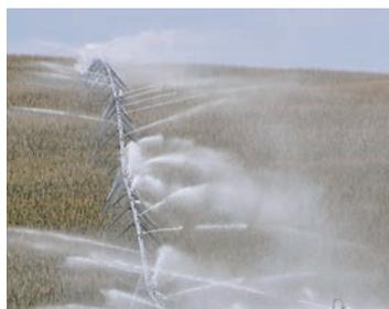
Die Senninger® Pivot Master Impulsregner verteilen das Wasser in einer niedrigen Flugbahn von 6° und sind so konstruiert, dass sie gegen Winddrift resistent sind. Ihr großer Streudurchmesser bedeutet, dass weniger Sprinkler benötigt werden.
