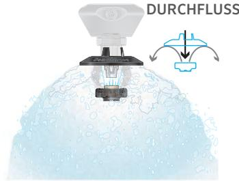
Der Shroud wird in Verbindung mit Deflektor-Pads verwendet, die einen Bubble- oder Chem-Pad-Einsatz enthalten. Der Shroud leitet das Wasser vom Einsatz in einem sanften kuppelförmigen Muster nach unten ab und sorgt so für eine vollständige Abdeckung des Feldes. Aufgrund seiner weniger konzentrierten Verteilung kann es auf Feldern ohne Furchen eingesetzt werden und wird oft zur Keimung sowie zur Bewässerung verwendet.
