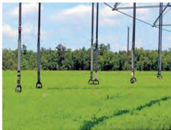
Das Senninger® Super Spray® verfügt über austauschbare Deflektor-Pads, um verschiedene Tröpfchengrößen, Nutzpflanzen, klimatische Bedingungen und Bodenanforderungen zu erfüllen. Durch den Abstand zwischen der Düse, dem Deflektor und den Halterungsbeinen ist sie ideal für Oberflächenwasser geeignet.
