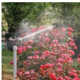
L'arroseur WedgeDrive™ de la série 20 dévie alternativement les débits à l'avant et à l'arrière de la cuillère lorsque le diffuseur réagit au jet d'eau entrant. Sa buse à orifice carré et sa vitesse de rotation rapide à 360° à basse pression assurent une distribution uniforme à proximité et à distance de l'arroseur.
