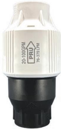
Le PRU (Pressure Regulator Ultra) est prévu pour gérer des débits plus élevés allant de 20 à 100 gpm (4 542 à 22 713 L/hr). Son entrée et sa sortie de 2" (50 mm) en font une solution de choix pour contrôler précisément la pression au niveau des zones et de chaque arroseur. Compact, il se loge facilement dans un boîtier d'électrovanne.
