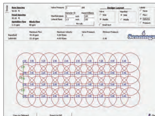
Le calculateur d'implantation rend compte de la conception des systèmes d'arrosage et fournit des informations spécifiques sur le débit, la vitesse et la pression le long des collecteurs et des lignes latérales.
