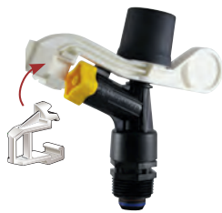
El difusor distribuye parte del caudal más cerca del aspersor para mejorar la uniformidad de la aplicación.
