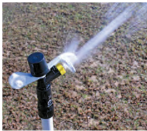
El difusor distribuye parte del caudal más cerca del aspersor para mejorar la uniformidad de la aplicación.
