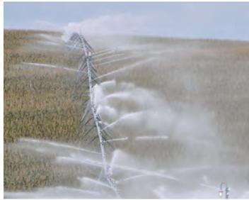
Los aspersores de impacto Pivot Master® de Senninger® distribuyen el agua con una trayectoria baja de 6° y están diseñados para resistir la deriva del viento. Su gran diámetro de alcance hace que se necesiten menos aspersores.
