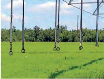
El Senninger® Super Spray® de tiene opciones de plato deflector intercambiables según distintos requisitos de tamaño de gota, cultivo, climas y suelo. Su diseño la hace ideal para aguas superficiales debido a la distancia entre la boquilla, el deflector y las patas del soporte.
