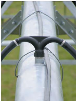
La instalación de cuellos de cisne dobles de 125° permite dividir el caudal de cada salida por la mitad para dos aspersores a cada lado de la línea principal. Esta duplicación de tubos colgantes se utiliza para convertir equipos con espaciamentos más amplios en máquinas con espaciamentos de tubos colgantes más estrechos.
