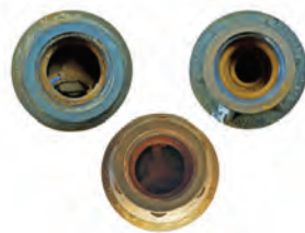
Впускные и выпускные отверстия изношенных регуляторов давления.
