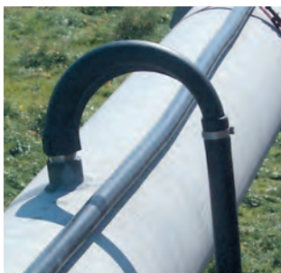
Pescoço de ganso simples de 180° com saída tipo espigão de 3/4" mostrada acima.
