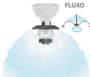
O Shroud é usado com placas defletoras contendo uma bolha ou inserto de placa de quimigação. O Shroud desvia a água do inserto para baixo em um padrão suave em forma de domo, proporcionando cobertura completa do campo. Devido à sua distribuição menos concentrada, pode ser usado em campos sem sulcos e é frequentemente usado para germinação, bem como para irrigação.
