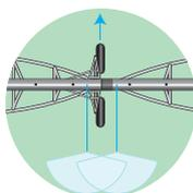
Monte o LDN® de rotação parcial de forma a pulverizar na direção oposta de deslocamento do pivô.
