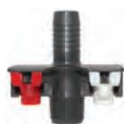
Projetado para ser utilizado no lugar do encaixe de rosca x barbeta padrão, o dispositivo comporta mais dois bocais UP3. Basta pressionar e puxar para remover os bocais e colocar e clicar para reinstalar. Os bocais podem ser identificados com facilidade pelos números nas orelhas. Quanto maior o número, maior a vazão.
