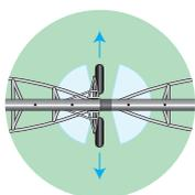
Monte o LDN® de rotação parcial de forma que a pulverização seja feita afastada das torres, independentemente da direção do pivô.
