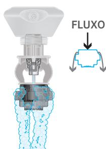
O lado do borbulhador da placa do defletor deposita suavemente a água na superfície do solo em um fluxo de bolhas. Esse fluxo aerado em cascata resiste aos efeitos do vento e da evaporação.
