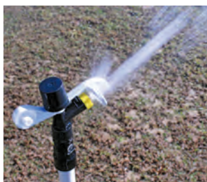
O difusor distribui parte do fluxo mais perto do aspersor para melhor uniformidade da aplicação.
