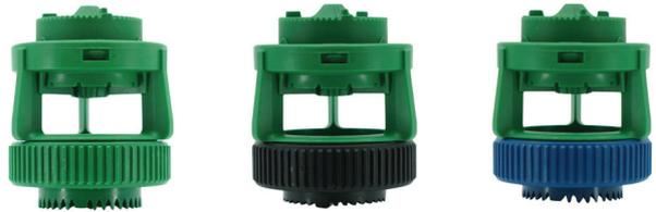
Además, los productores pueden elegir el conjunto de Wide Spray Bubbler en función de la trayectoria del plato de pulverización inferior. El plato convexo verde direcciona el agua hacia abajo, el plato negro es plano y el plato cóncavo azul tiene trayectoria hacia arriba. Esto les permite convertir fácilmente una aplicación de burbuja LEPA al patrón de pulverización que mejor se adapte a sus necesidades.
