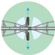
Montieren Sie den Part-Circle LDN so, dass er unabhängig von der Richtung des Drehpunkts von den Türmen weg spritzt.
