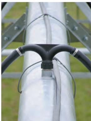
Durch die Installation doppelter 125°-Schwanenhälse kann der Durchfluss von jedem Auslass in zwei Hälften aufgeteilt werden, sodass zwei Regner auf beiden Seiten der Hauptleitung entstehen. Diese Verdoppelung der Tropfen wird verwendet, um Maschinen mit größerem Abstand auf engere Tropfenabstände umzustellen.
