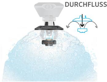
Der Shroud wird in Verbindung mit Deflektor-Pads verwendet, die einen Bubble- oder Chem-Pad-Einsatz enthalten. Der Shroud leitet das Wasser vom Einsatz in einem sanften kuppelförmigen Muster nach unten ab und sorgt so für eine vollständige Abdeckung des Feldes. Aufgrund seiner weniger konzentrierten Verteilung kann es auf Feldern ohne Furchen eingesetzt werden und wird oft zur Keimung sowie zur Bewässerung verwendet.
