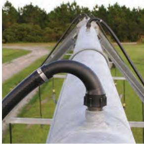
Durch die Installation von einzelnen 125°-Schwanenhälsen auf abwechselnden Seiten der Hauptleitung wird der benetzte Anwendungsbereich vergrößert und kann dazu beitragen, die Einwirkzeit zu verlängern.
