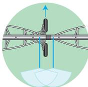
Befestigen Sie das Teilkreis-LDN, um in die entgegengesetzte Richtung zu sprühen, in die sich der Drehpunkt bewegt.
