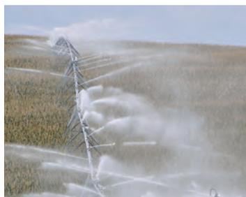
Die Senninger® Pivot Master® Impulsregner verteilen das Wasser in einer niedrigen Flugbahn von 6° und sind so konstruiert, dass sie gegen Winddrift resistent sind. Ihr großer Streudurchmesser bedeutet, dass weniger Sprinkler benötigt werden.
