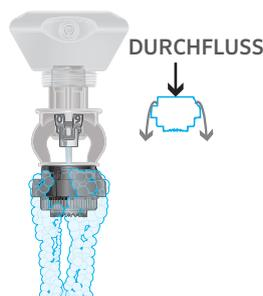
Die Sprudelseite des Deflektor-Pads gibt das Wasser in einem sprudelnden Strahl sanft auf die Bodenoberfläche ab. Dieser belüftete, kaskadenförmige Bach widersteht den Auswirkungen von Wind und Verdunstung.
