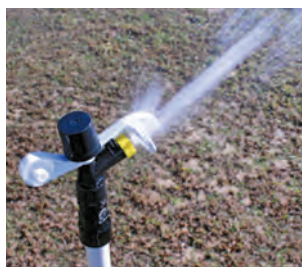
Le diffuseur distribue une partie du débit près de l'arroseur pour une meilleure uniformité d'application.
