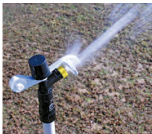
Der Diffusor verteilt einen Teil des Wasserstroms näher am Regner und sorgt so für eine gleichmäßigere Ausbringung.
