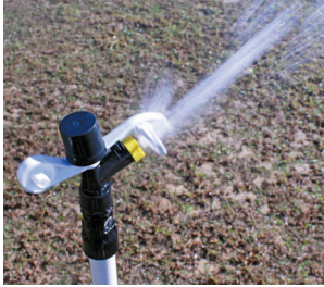
Difüzör, uygulama homojenliğini artırmak için debinin bir kısmını sprinkler yakınına dağıtır.
