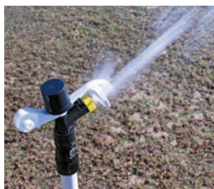
Le diffuseur distribue une partie du débit près de l'arroseur pour une meilleure uniformité d'application.
